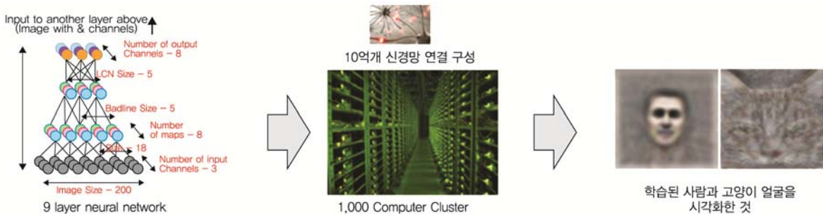
(그림 9) 구글 시스템 학습 알고리즘 구성도
