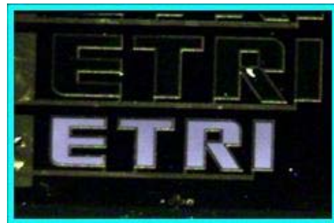
(그림 12) ETRI에서 개발한 실리콘 발광소자의 전계발광 장면
