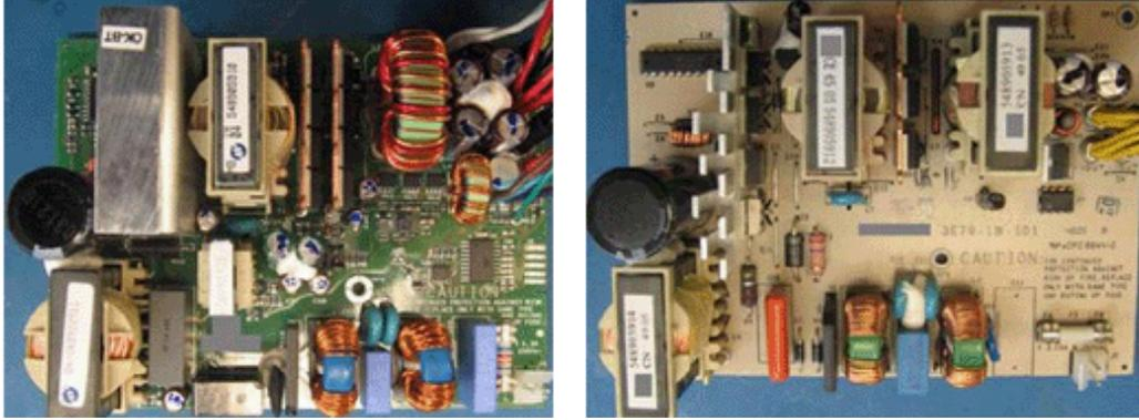
(그림 7) 기존의 PSU(좌)와 12V 만 생성하는 PSU(우) 내부모습[4]
