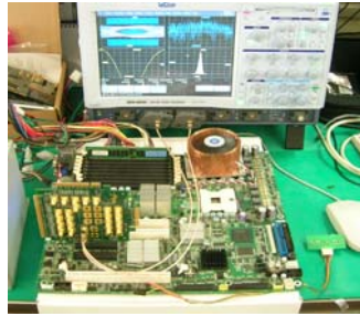
(그림 13) CLB(좌)와 CBB(우)를 사용한 PCI Express 시스템의 전기 파라미터 측정 사진
