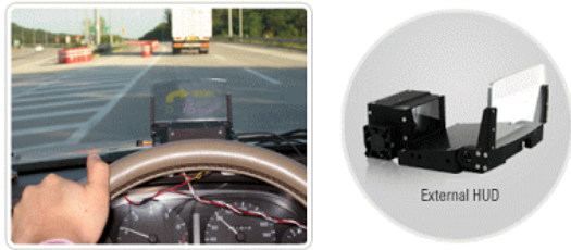
(그림 6) 외장형 HUD 시스템의 실제 적용 사례
