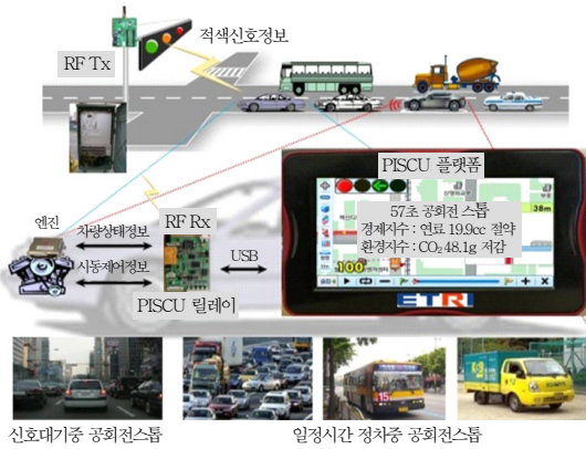
(그림 3) IT 융합 Stop-Start 시스템
