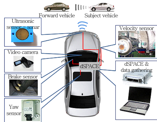
(그림 9) 강남대로 주행시 Stop-Start 시험 구성 장치
