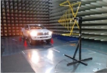
(그림 11) 자동차 EMI/EMC 테스트
