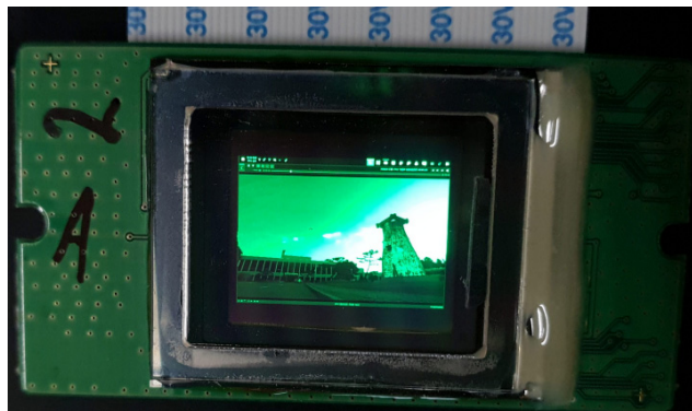
[그림 3] ETRI에서 개발한 OLED 마이크로디스플레이 구동 이미지
