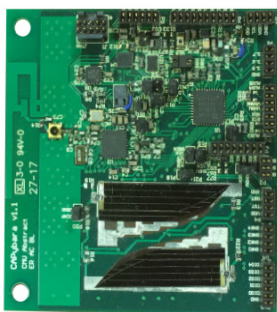
[앞면: solar panels, microcontroller, radio와 5개 센서 장착]
