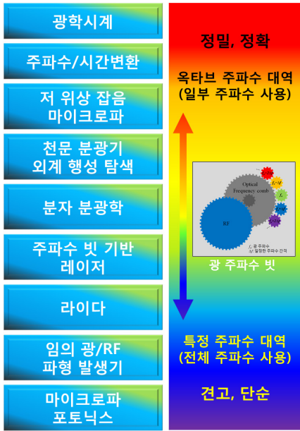
그림 6 광 주파수 빛의 특성(정확성, 견고성, 단순성, 스펙트럼 대역폭, 주파수 빛의 개수)에 따른 응용 분야 예시[11]
