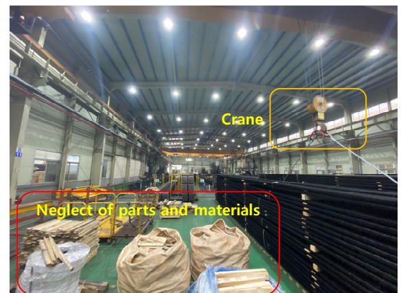
그림 2. 공장내 작업위험 요소(크레인, 부품자제 방치) Fig. 2. Risk factors for work in the factory (crane, neglect of parts and materials)
