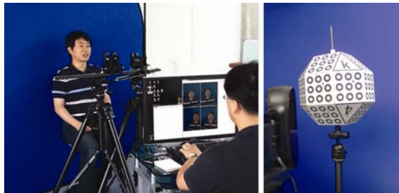
(그림 12) 자연조명 환경에서 얼굴 데이터 획득 예(a) 및 카메라 보정 구조물(b)
