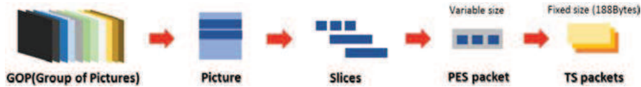
그림 1. MPEG-2 시스템의 Elementary Stream 패킷화 과정 Fig 1. The packetization process of elementary stream in MPEG-2 system
