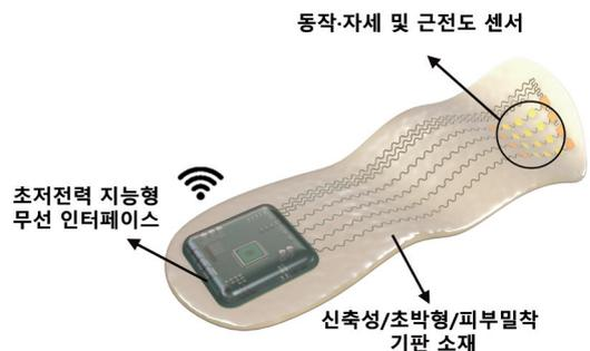
그림 1 무선 독립패치형 무자각 동작·자세 및 근전도 센서 개념도
