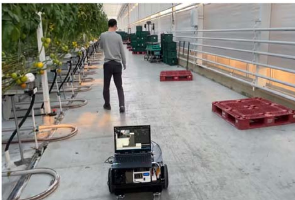
그림 10. 온실 환경에서의 작업자 추종 실험 Fig. 10. Worker following experiments in a greenhouse environment
