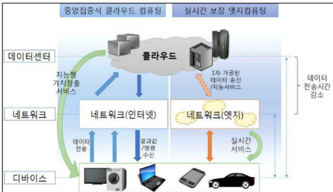
( 그림-13 ) 사물인터넷을 위한 실시간 보장 엣지 컴퓨팅의 특징과 구조 비교
