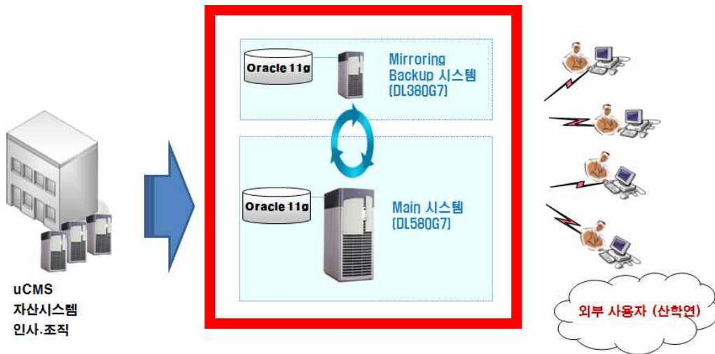
(그림 10) 연구장비 지원시스템 H/W 구성도
