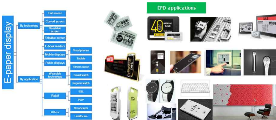
(그림 2-6) EPD로 대별되는 전자종이제품 분류 및 EPD 필름을 적용한 다양한 응용 상품들
