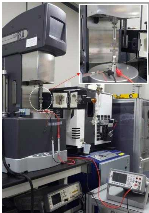
그림 3-9. PDMS-g-PTBA 구동용 전극의 반복적 변형 인가에 따른 전기저항 변화 특성 측정 시스템 사진
