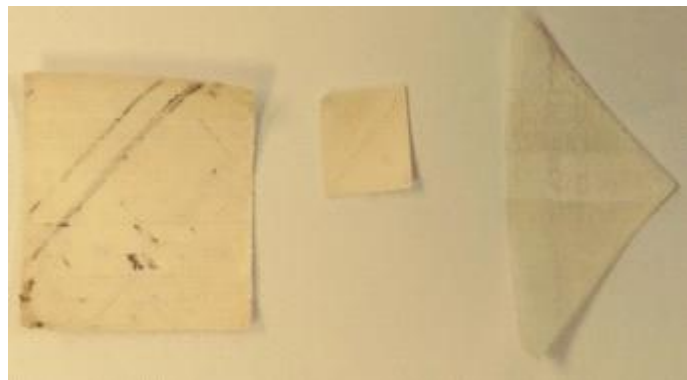
그림 30. 고온용 3D 프린터의 프린팅 후 열수축 후 변형 사진
