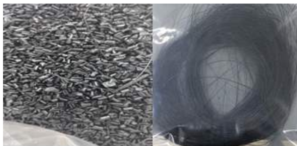
그림 9. 펠릿화 및 필라멘트화 된 폴리설펜, 카올린, 카본블랙 복합소재
