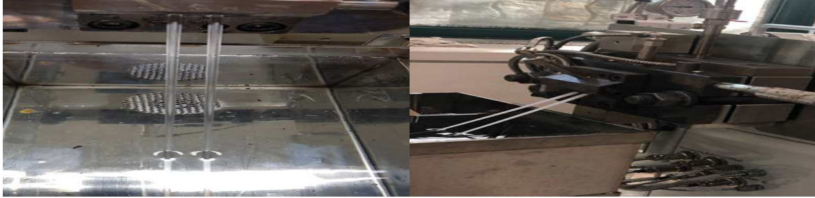
그림 4. 이축압출기 다이부분에서 용융된 복합소재 분출하는 모습
