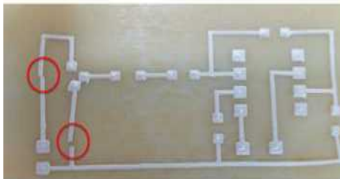
그림 39. 높은 온도에 따른 Ag 배선의 damage와 기판 변형
