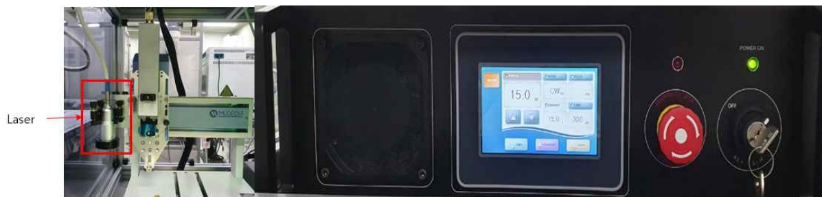
그림 35. Cu paste 배선 및 Laser 열경화를 위한 통합 장비
