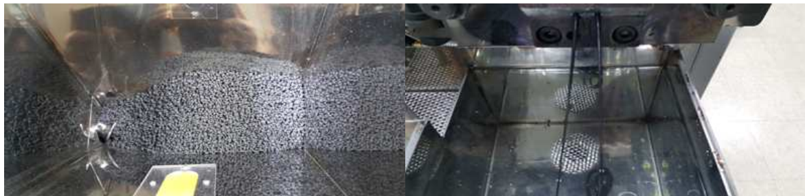
그림 6. 압출 호퍼부분과 carbon black 첨가로 인한 변색된 고분자복합소재
