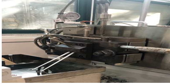
그림 5. 컴파운딩된 복합소재의 냉각공정
