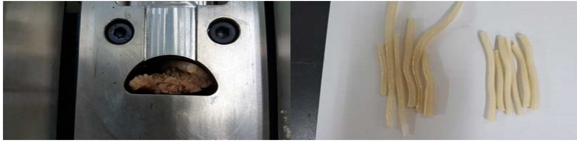
그림 2. 진공 vent 부분에 수지가 올라오는 현상과 취성이 감소되는 현상
