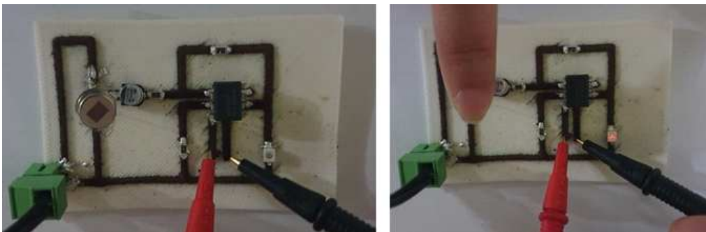
그림 52. 인체감지센서 작동에 따른 LED 소자의 점등 변화
