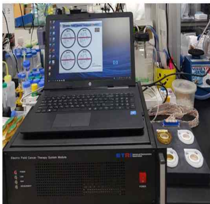
<자체 제작된 전기장 치료기기를 세포 실험실에 설치한 모습>
