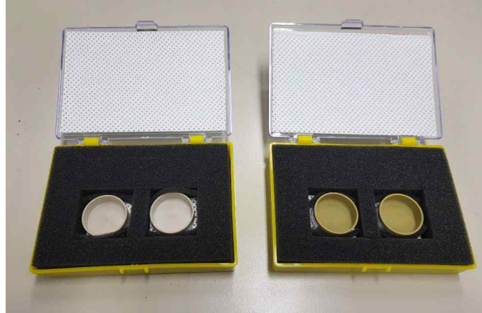
<왼쪽: 다결정 PMN-PT성분 접시형 강유전 전극, 오른쪽: 단결정 PMN-PT성분 접시형 강유전 전극>
