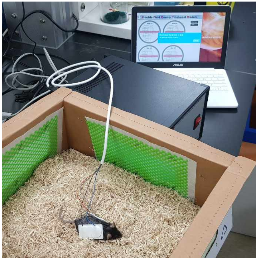
<입는 전기장 치료기기 시작품을 이용한 전임상 테스트 사진>
