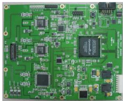
(그림 4-11) IMT-Advanced 단말 시스템용 RF 인터페이스 보드
