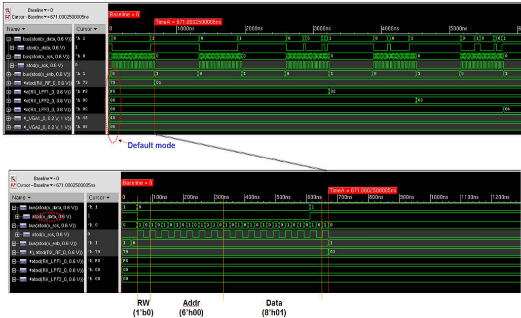
(그림 4-1) UDMR Receiver 기능제어용 SPI 시험 (정상동작 확인)
