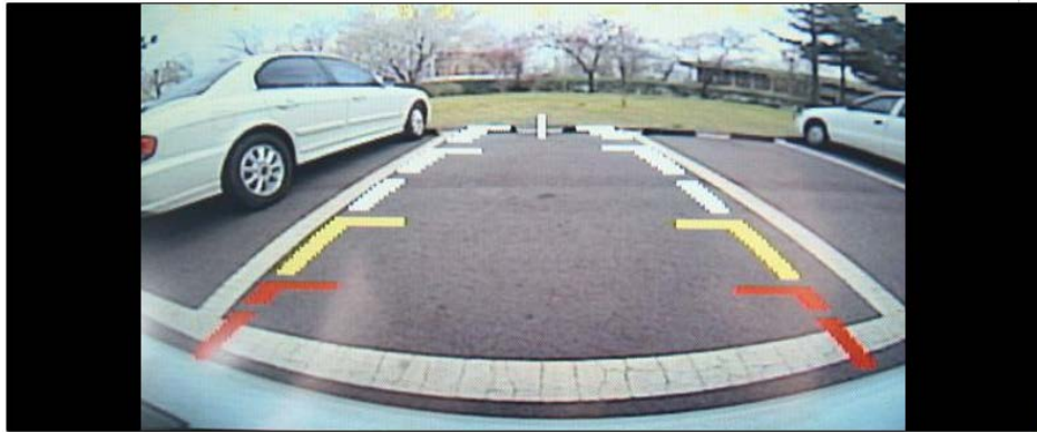
(그림 2-2-17) 후진 시 후방카메라 표시 화면
