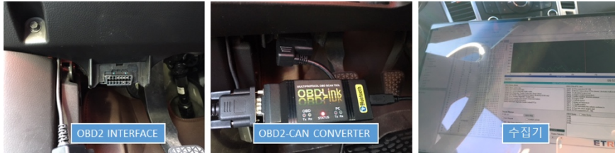
(그림 2-1-75) 차량정보 수집 시스템 차량 연동
