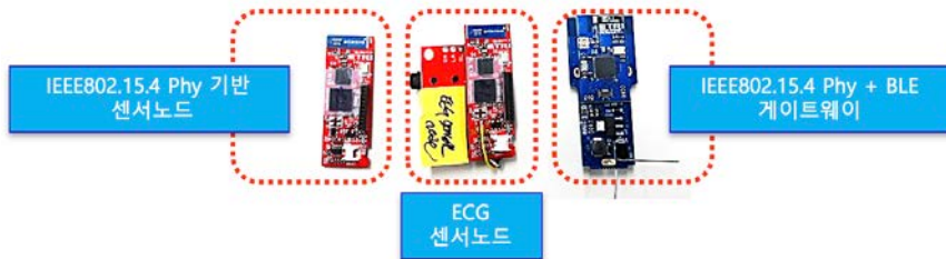
(그림 2-1-72) 무선 센서 네트워크 기반 ECG센서노드
