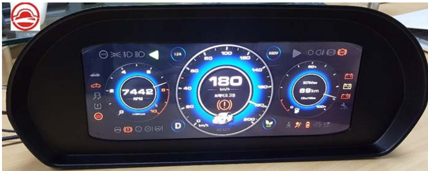
(그림 2-2-18) 12.3인치 체리자동차 고급형 멀티클러스터 시제품
