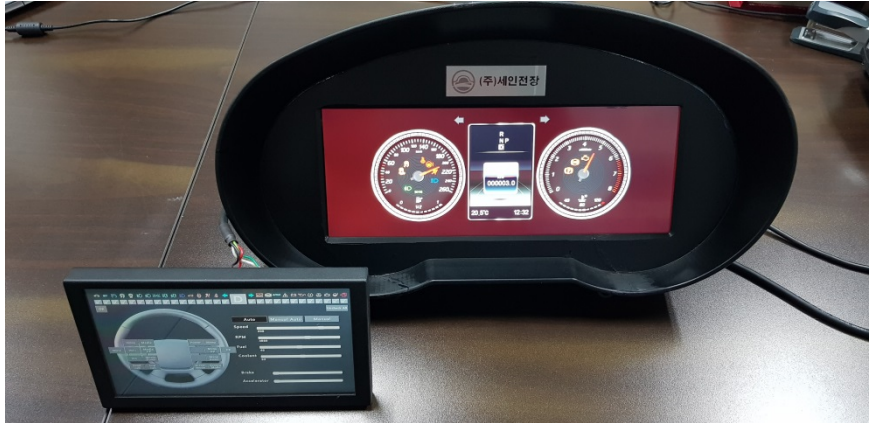
(그림 2-2-20) 12.1인치 벤츠UI 클러스터 및 시뮬레이터 시제품
