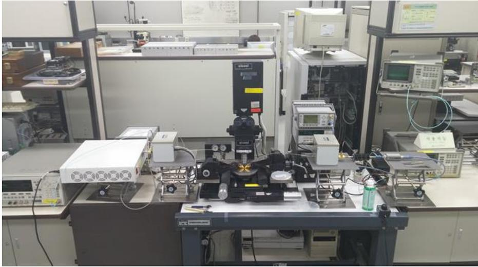
[그림 2-17] 30GHz 로드풀 측정 시스템
