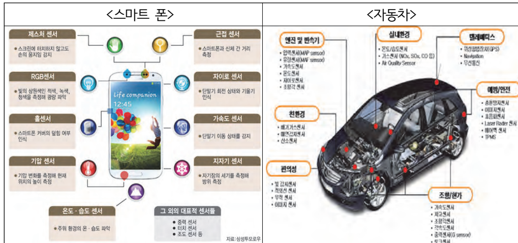
[그림 2-3] 스마트폰과 자동차 등에 내장된 대표적 센서
